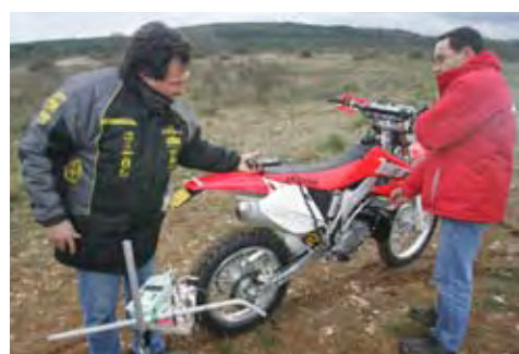
Contrôle du niveau sonore à l'aide d'un sonomètre, au départ d'une compétition.
